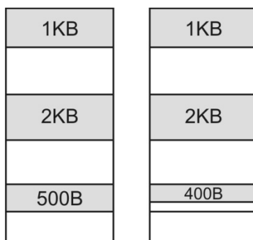
Слика 6.17: Пример за сместување на n бајти, се користи најмалиот расположив слободен блок поголем од n , во случајов за сместување на 400 бајти, го користиме третиот блок (најмалиот)
