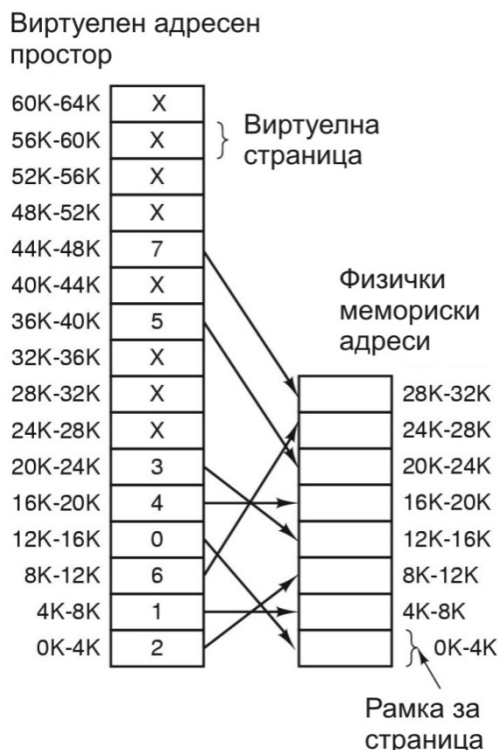
Слика 7.2: Пример за пресликување на виртуелниот во физички адресен простор
