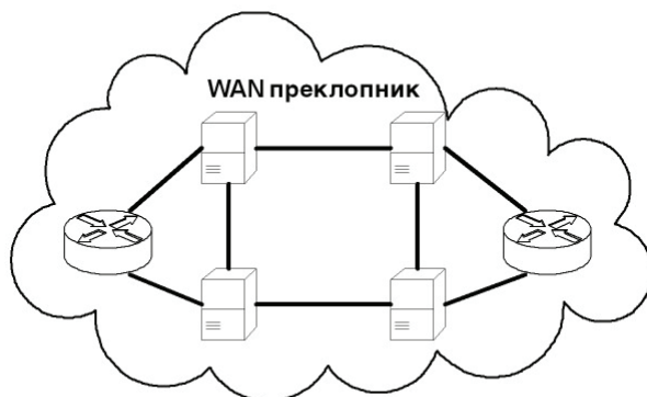
Слика 6.5: Два рутери на краевите на WAN мрежата може да се поврзат преку WAN преклопници
