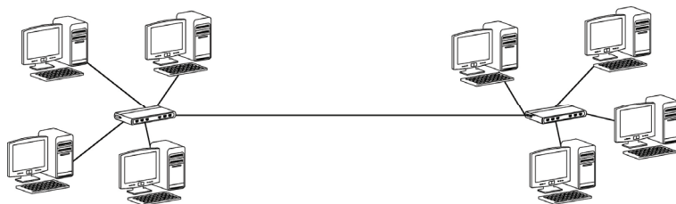
Слика 3.13: Хибридна топологија
