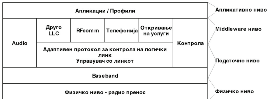
Слика 7.14: Верзијата 802.15 на Bluetooth протоколната архитектура
