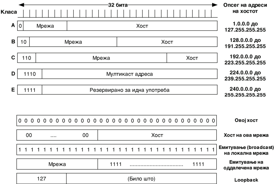
Слика 8.7: Класи на Интернет мрежи и резервирани адреси
